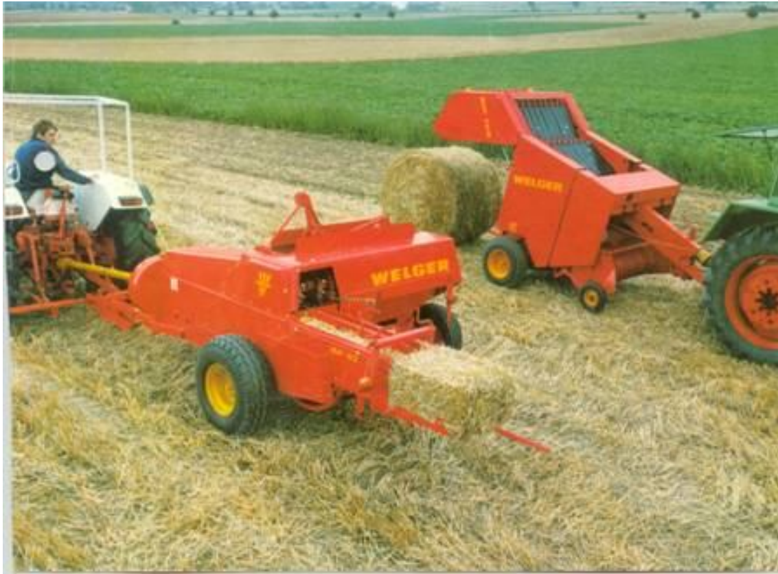
Köşeli ve silindirik balya makinaları
