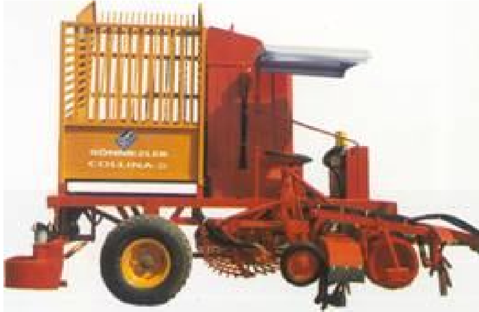
Hidrolik tahrikli depolu bantlı boşaltma sistemli yerli hasat makinesi
