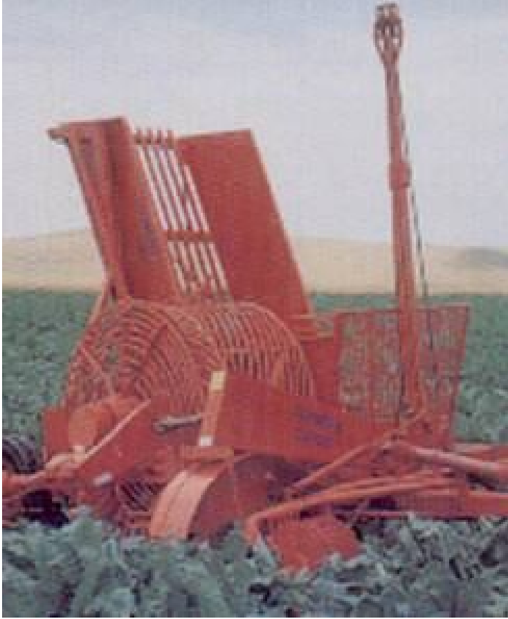
Ön yaprak temizleyicili ve depolu yerli hasat makinesi
