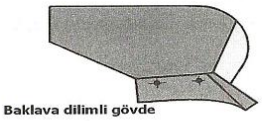
Şekil 5.10. Önemli pulluk gövde formları [8].
