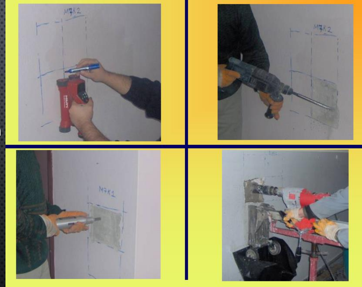
Beton Karot Alımı Öncesi Hazırlık
