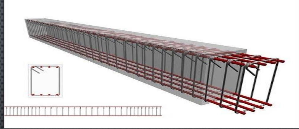
Kiriş Donatı Detayı (Üç Boyutlu Görünüş)
