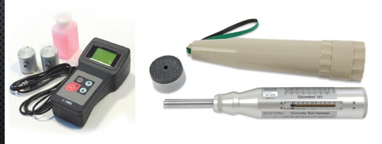
Betonun Tahribatsız Tahkikinde Kullanılan Çeşitli Aletler
