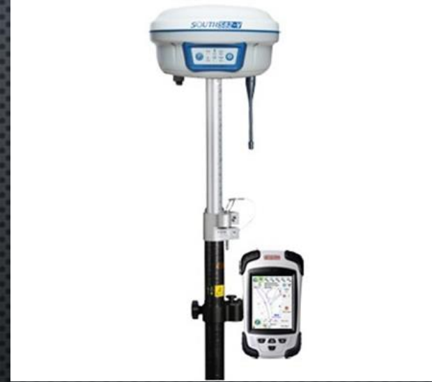
İnşaat Aplikasyon İşlemlerinde Kullanılan GPS Cihazı
